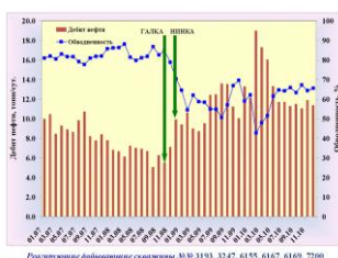
Увеличение добычи нефти для участка паранагнетательной скважины № 6168 пермокарбонатной залежи Усинского месторождения после закачки композиции ГАЛКА®-С и нефтewытесняющей композиции НИНКА®
